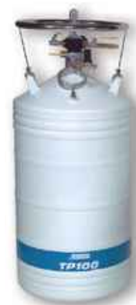
Suministro de N 2 líquido: Recipiente autopresurizado TP
